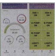
ทั้งนี้จะมีการติดตั้งเช็นเซอร์วัดค่า เพื่อตรวจสอบค่า และส่งค่าที่ประมวลผล ชิ้นปั้มน้ำระบบไฟแสงสว่างสำหรับการเจริญ อินเทอร์เน็ดไปแสดงผลผ่านบนแอพพลิ ต่าง ๆ ไว้ในระบบโรงเรือน ค่าที่วัดได้จะ แล้วไปควบคุมอุปกรณ์ต่าง ๆ เช่น ปั๊มจ่าย เติบโตของพืชและพัดลมระบายอากาศ เคชั่น บนสมาร์ทโฟน ทำให้ผู้ใช้งานสามารถ ถูกส่งไปประมวลผลโดยไมโครคอนโทรลเลอร์ สารละลายธาตุอาหารในน้ำ เครื่องทำความ นอกจากนี้ค่าที่วัดได้ยังถูกส่งผ่าน ทราบข้อมูลเกี่ยวกับสภาวะแวดล้อมต่าง ๆ
